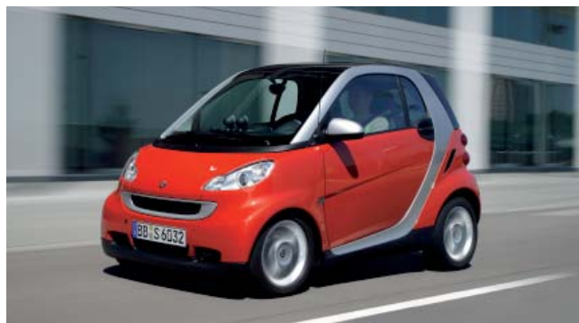
Ook Smart levert tegenwoordig een zogenaamd microhybride-systeem, waarbij de motor bij stationaire loop wordt uitgeschakeld. Na een trap op het gaspedaal springt hij weer aan.
