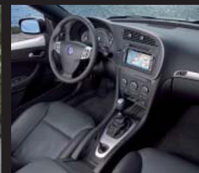
Het dashboard heeft de bekende cockpitstijl van Saab. Het contactslot zit tussen de voorstoelen.
